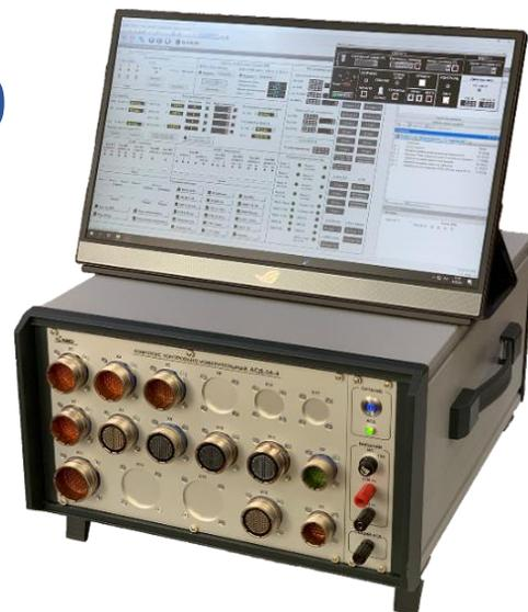
**Свободно конфигурируемые пользователем состав функциональных модулей комплекса и приборная панель для подключения к объектам контроля** – позволяет формировать контрольно-диагностический комплекс под текущие задачи
